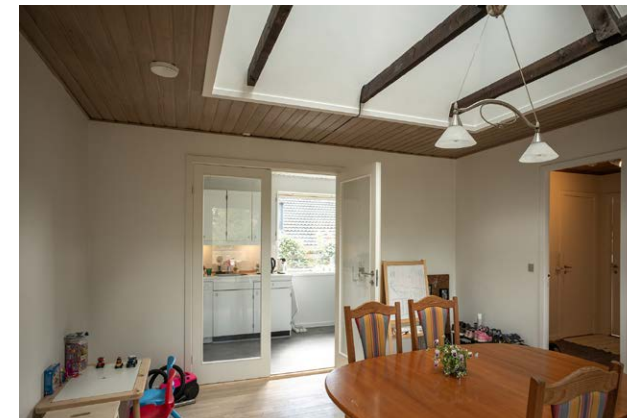
Før og efter: I parcelhuset fra 1962 blev der skabt markant mere dagslys i stuen ved hjælp af ovenlysvinduer og åbning mod køkkenet med en glasskydedør, som er indsat for, at man kan lukke af for stegeos under madlavning (se også side 17).
