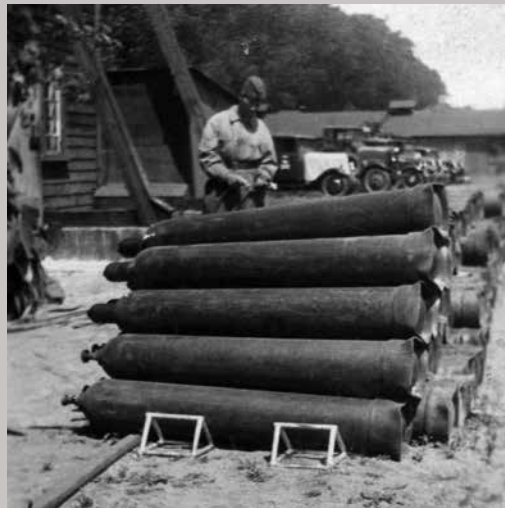
Ballonmandskabet havde nok at se til. En af opgaverne var at fylde ballonerne med brint, som ankom i patroner. Fotos 1918-1932.
